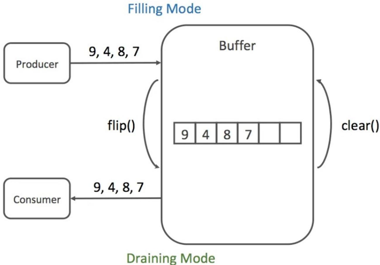
operazioni `flip()` e `clear()` modificano le variabili di stato nel passaggio dallo stato Filling allo stato Draining
